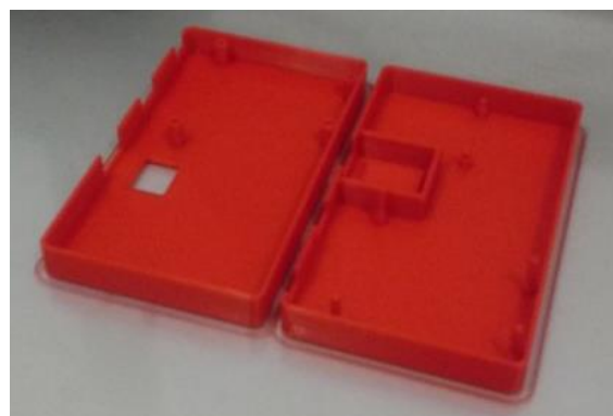
Figura 1 - Case construída em impressora 3D (Fonte Autor)
